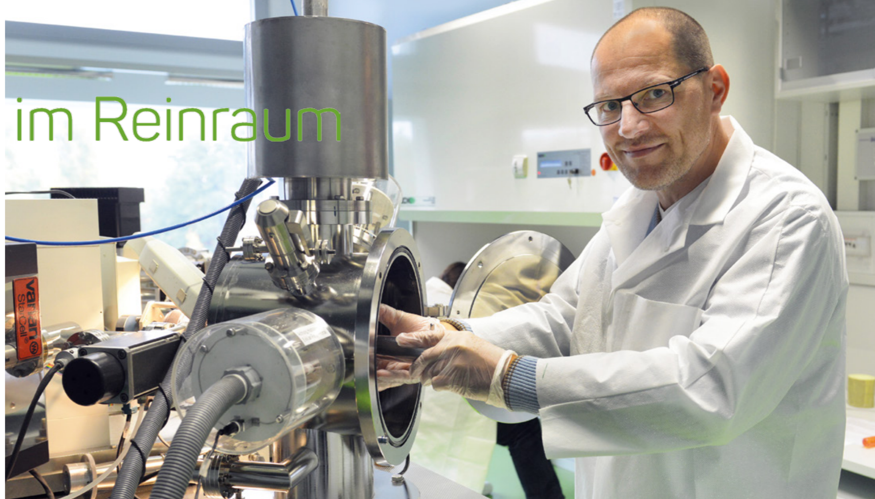
Jochen Vogl wechselt am Thermionen-Massenspektrometer das Probenkarussell
